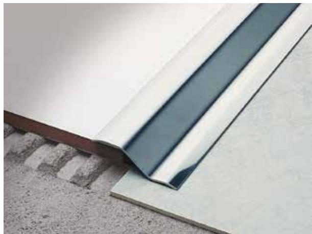
VARIOTEC DK ist ein selbstklebender Kantenschutz, der stufenlos Höhenunterschiede von 7 bis 16 mm abdecken kann. Dieses Profil ist sehr schnell und leicht anzubringen. Für die Montage das Profil auf die gewünschte Länge zuschneiden. Kleberschutzfolie entfernen und auf den Untergrund aufdrücken. Um eine gute Haftung zu erzielen, muß der Untergrund fest, eben, sauber, trocken und fettfrei sein.
